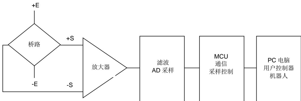
为方便使用，小信号输出型传感器可以选配 SRI 信号放大器(M830X)或数据采集卡(M812X)。
