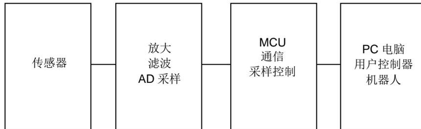
为方便使用，内置放大器型传感器可以选配 SRI 数据采集卡(M812X)，以直接获取传感器力和力矩信号。
